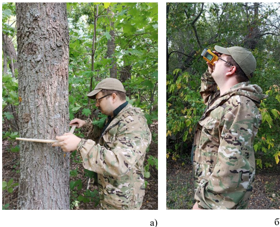
Рисунок 2.6 – Измерение диаметра ствола (а) и высоты дерева (б)
